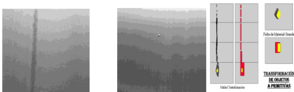
Figura 7. 25 Ejemplos de dos tipos de defectos en el aluminio colado y su clasificación con métodos sintácticos: a) Mala cristalización, b) Desperfecto superficial.
