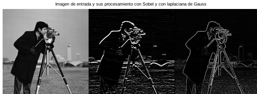
Figura 4. 15 Diferencias entre el operador gradiente y el operador laplaciana
