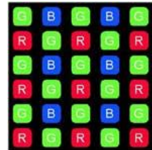
Figura 2. 51. 1CCD con filtro de Bayer
