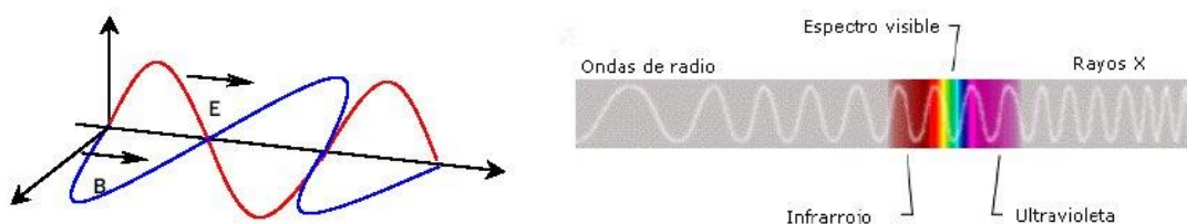
Figura 1. 3 a) Campo electromagnético b) Espectro de la luz
